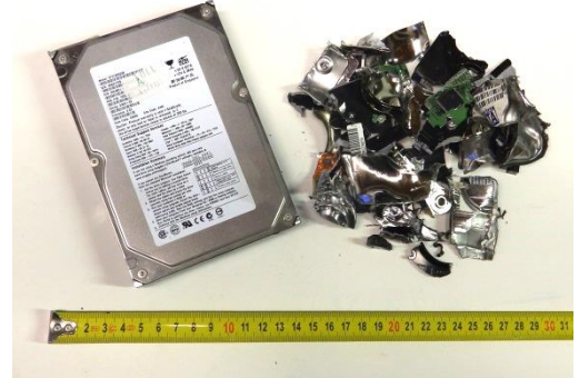
Partikelgröße nach dem Zerkleinern mit JBF HD 38/54
