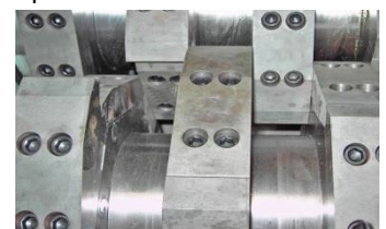
Segmentmesser, in der Maschine tauschbar ohne Ausbau der Messerwellen
